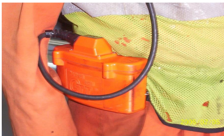
شکل ۲-۳- نحوه قرارگیری چراغ معدنی
